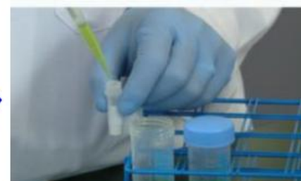
5. transfer supernatantu do zkumavky pro disperzní SPE
